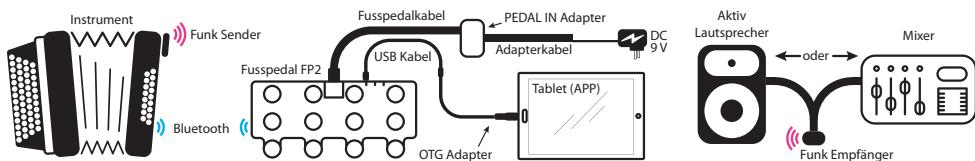
**Hinweis:** Um das BT erstmals mit dem Instrument zu verbinden öffnen sie das Info Fenster am Instrumentendisplay. Um das Pairing durchzuführen drücken Sie kurz die Selekttaste des Instrumentes und danach auf Bluetooth im Infowfenster. Nun sollte der Name des Limex Bluetooth Modul am Display erscheinen. Zum Verbinden einfach auf den Namen im Display drücken. Nun sind das Instrument und das FP2 mittel Bluetooth verbunden. Von nun an ist kein weiteres Pairing mehr nötig.
